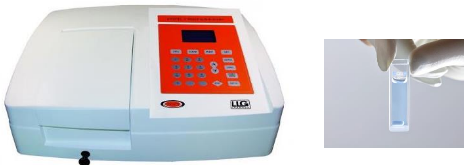
Rysunek 12. Jednowiązkowy spektrofotometr UV-Vis firmy LIG-uniSPEC oraz kuweta pomiarowa
